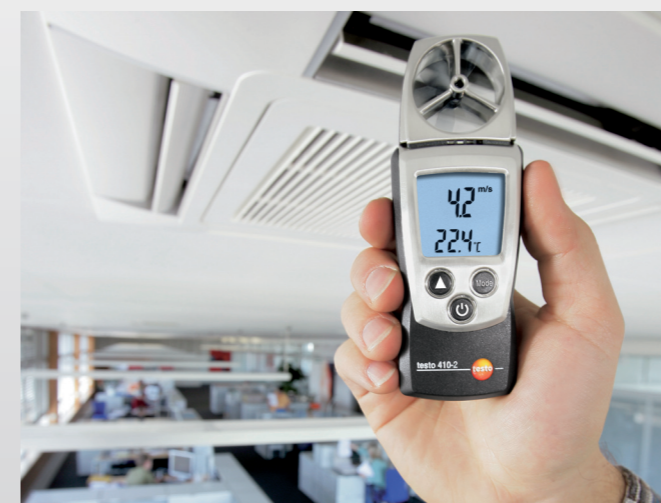
Pomiar prędkości przepływu na kratkach za pomocą wiatraczka Ø 40mm
