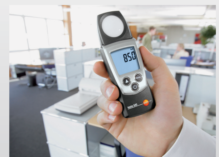
Pomiar natężenia światła w miejscu pracy
