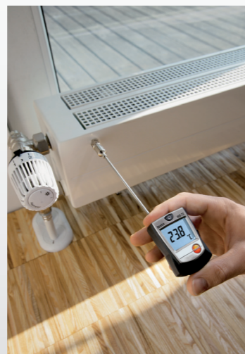
Pomiar temperatury powierzchni na grzejniku
